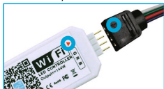
Podłączenie kontrolera do taśmy LED RGB
